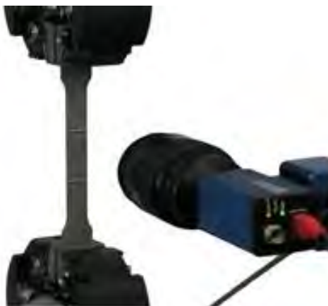
图 1.1 二维数字图像相关测量装置。
