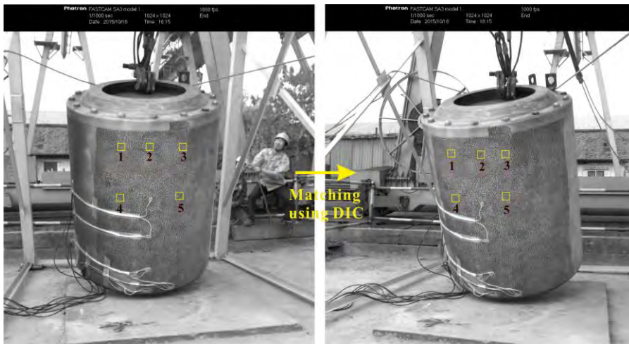
图 4.6 左右图像中的散斑匹配点。
