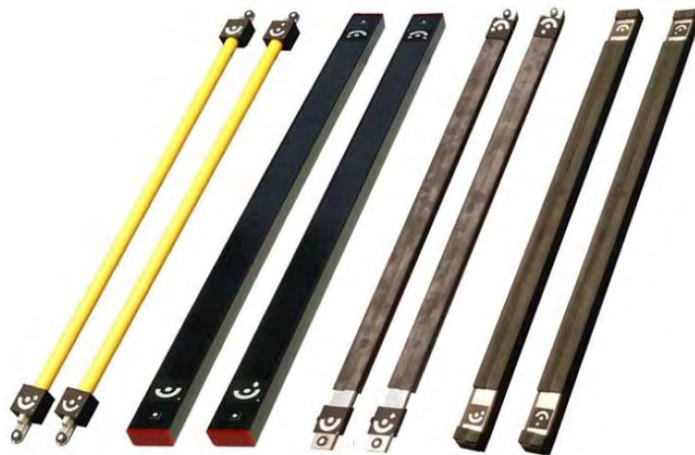
图 4.7 摄影测量中的标定尺。
