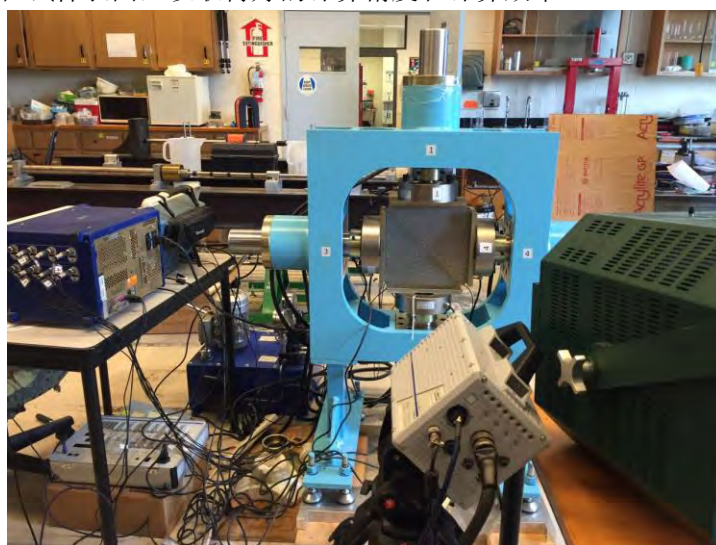
图 3.10 基于霍普金森杆加载的实验室地震实验装置图。
