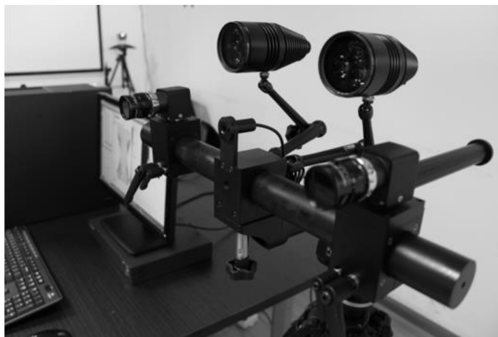
图 1.3 三维数字图像相关测量装置。
