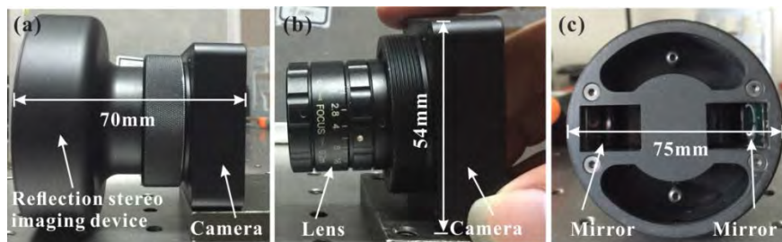
图 5.2 单镜头三维视频引伸计的实际装置图。
