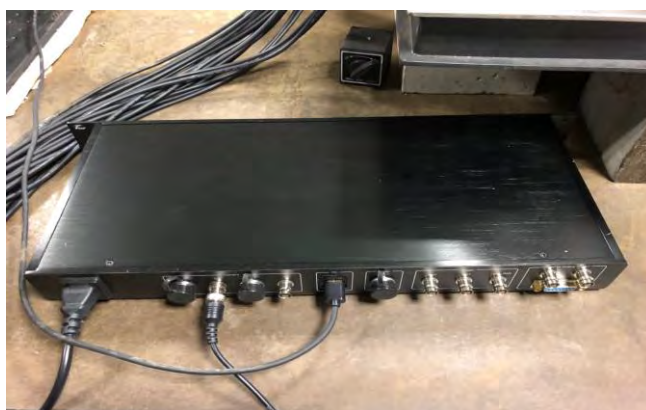
图 6.14 硬同步触发采集器。
